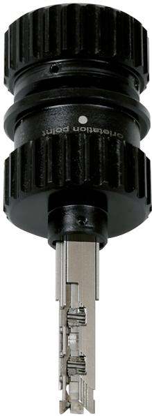
Pour vous le côté important est celui, où le testeur de générations se laisse introduire jusqu'aux marquages prédéterminés. S'il s'arrête sur le marquage rouge, il s'agit d'une serrure de génération 1, s'il s'arrête sur le marquage vert, il s'agit d'une serrure de génération 2/6.
