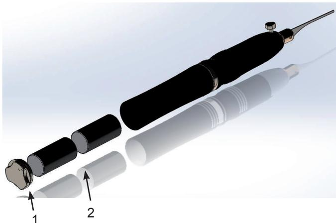
Para insertar las baterías, desenrosque la tapa de la base del cuerpo cilíndrico de la ganzúa. Preste atención a los polos positivo (+) y negativo (-). El extremo del polo positivo debe introducirse primero. La tapa de rosca es el polo negativo.
