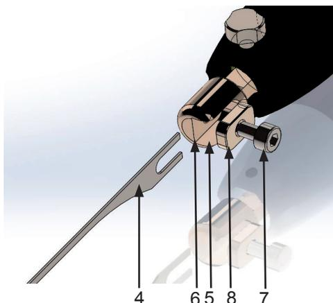
Desatornille el tornillo de sujeción (7) con la llave Allen suministrada. Introduzca la base de la punta/cuchilla (4) en la ranura del cabezal (8) por debajo de la abrazadera (5) y deslícela completamente hasta el tope. Apriete el tornillo de sujeción (7) con la llave Allen Torx T10 para que la punta quede bien sujeta.
