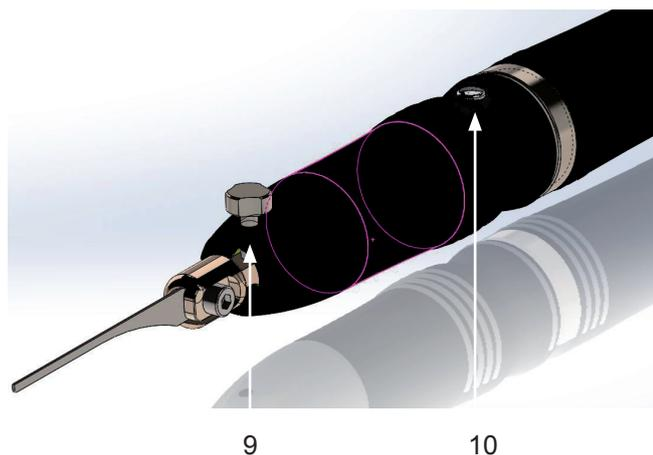
Para encender el Multipick ARTEMIS, pulse el botón de accionamiento (10) del dispositivo. Tan pronto se deja de presionar el botón de accionamiento (10), la ganzúa eléctrica ARTEMIS se apaga.
