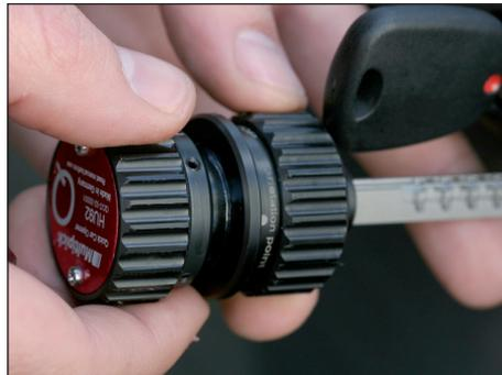
Etape 7 : Tournez la « molette de tension » du décodeur MP-Q vers la gauche et maintenez la tension; en même temps vous tournez la « molette à pompe » dans la même direction jusqu'à la marque d'arrêt sur le décodeur MP-Q et ensuite dans le sens opposé. Lachez maintenant la tension et essayez d'ouvrir. Répétez ce processus jusqu'à ce que la serrure s'ouvre.
