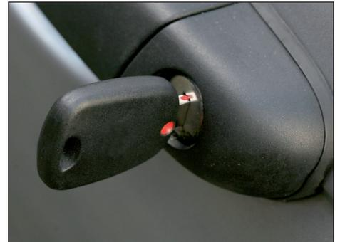
Si le point rouge de la clé teste montre vers la droite, le point d'orientation du décodeur MP-Q doit également montrer vers la droite. Si le point montre vers la gauche, aussi le point d'orientation doit montrer vers la gauche.
