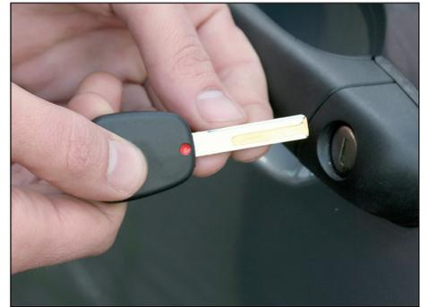
Ces deux points vous montrent la direction dans laquelle vous devez introduire le décodeur MP-Q dans la serrure automobile. Dans ce but le décodeur MP-Q dispose d'un « Point d'Orientation ».
