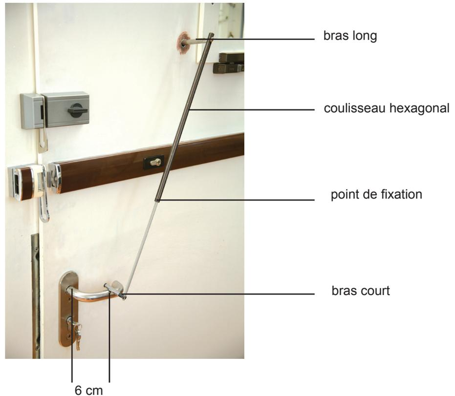
Après le réglage des longueurs on introduit l'un après l'autre les trois éléments mobiles avant à travers le trou du judas. En introduisant les segments sur ressort se plient automatiquement dans les positions souhaitées.
